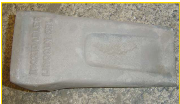
► Uña de retroexcavadora
